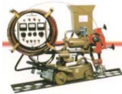
Σχήμα (9.20): Σύστημα ηλεκτροσυγκόλλησης SAW
